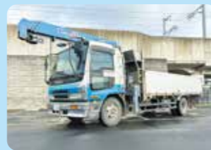
4tユニック車 1台
